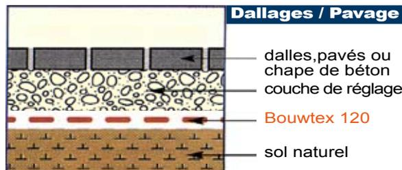
Fissures affaissement : de nombreux ouvrages tels que les terrasses (dallages, pavages), les dalles béton ou enrobés, les tennis... subissent des dégradations qui peuvent être évitées. Le géotextile Bouwtex 120, par sa qualité de séparation forme une barrière entre le sol naturel et les couches supérieures, évitant ainsi les désagréments préjudiciables à la pérennité de ces ouvrages.
