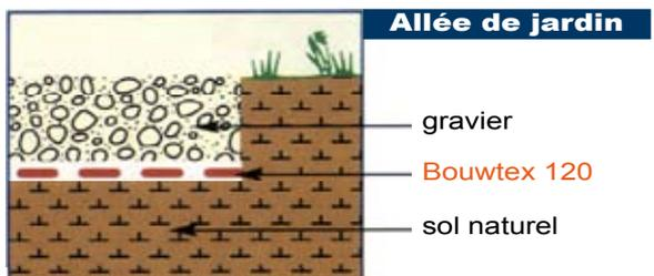
En séparant le sol naturel des graviers, sables et autres sous-couches de voies d'accès avec un géotextile Bouwtex 120, vous assurez à vos chemins, allées et espaces gravillonnés une tenue optimale.
