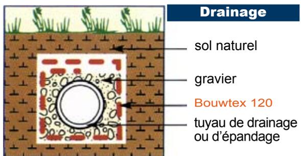
L'utilisation du géotextile Bouwtex 120 pour les ouvrages de drainage évite le mélange des terres et le colmatage des drains grâce à leurs fortes capacités filtrantes.
